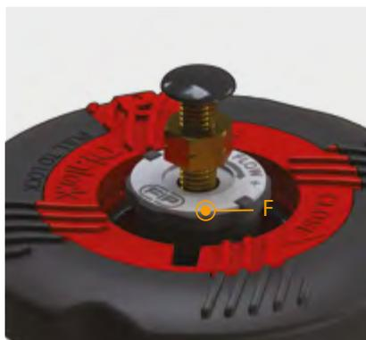
Мембранный клапан исполнения DKL оснащен инновационной системой регулирования хода маховика, позволяющей регулировать максимальную и минимальную пропускную способность клапана и предупреждать слишком сильное сжатие мембраны при закрытии.
